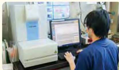
東ソー株式会社「TRC Ready-80」 遺伝子検査を行うための機械です
