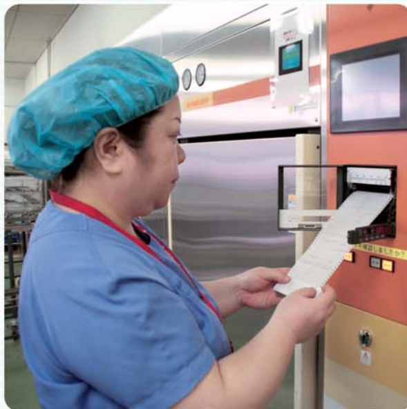
高圧蒸気滅菌器のモニタリング（工程確認）を行っているところです。
