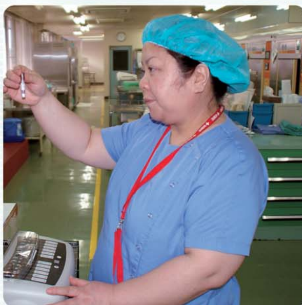
生物学的インジケータ（微生物の死滅）を確認しているところです。
